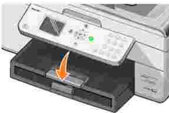
5. Etendez le bord d'arrêt du bac de sortie pour retenir le papier lorsqu'il sort de l'imprimante.
